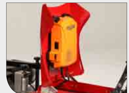
Die Pellenc ULiB Batterie treibt die Kehrmaschine über 3 Stunden emissionslos an.
