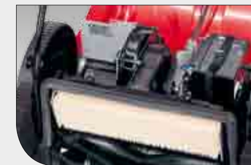
Der leicht zugängliche Lamellenfilter sorgt für ein staubfreies Arbeiten.
