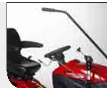
Vom Fahrersitz aus sind Wurfwinkel und Wurfhöhe zu steuern
