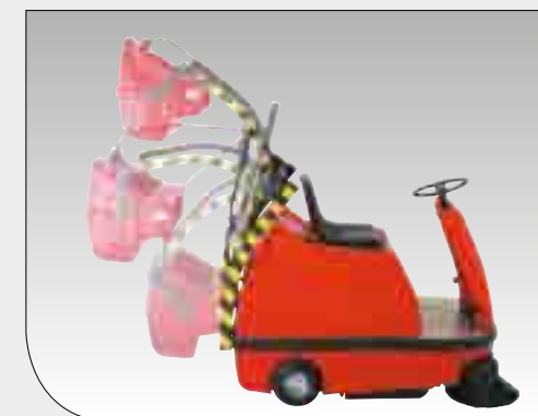
Die optionale Hochentleerung sorgt für müheloses Entleeren des Kehrgutbehälters.
