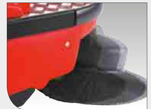
Die Seitenbesen weichen Hindernissen selbständig aus.
