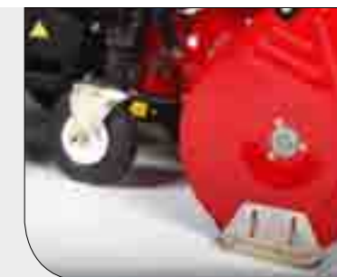
Stützräder und Gleitkufen zur Entlastung der Vorderachse
