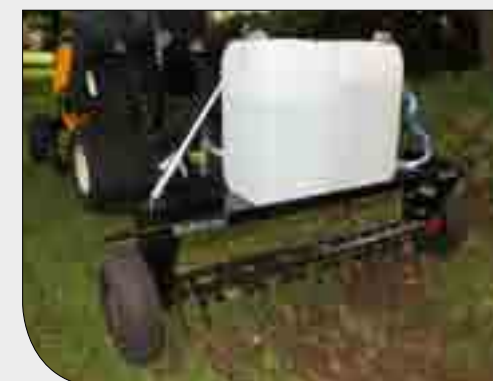
AG-223-001TS Harke Zur Beseitigung von Moos und Verfilzung in Rasenflächen.
