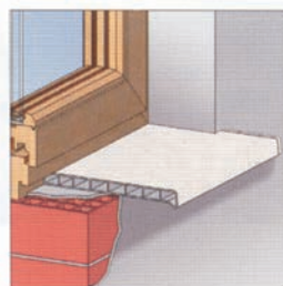
einfache Montage z.B. mit: Montage-Klebstoff 2K-Montageschaum
